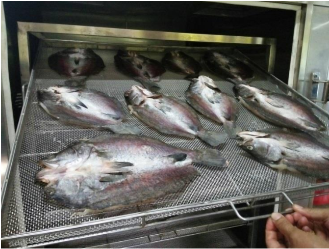
ภาพที่ 17 ขั้นตอนการนำปลากะพงเข้าตู้อบลมร้อนที่ 70 องศา ใช้เวลาอบ 4 ชม.
